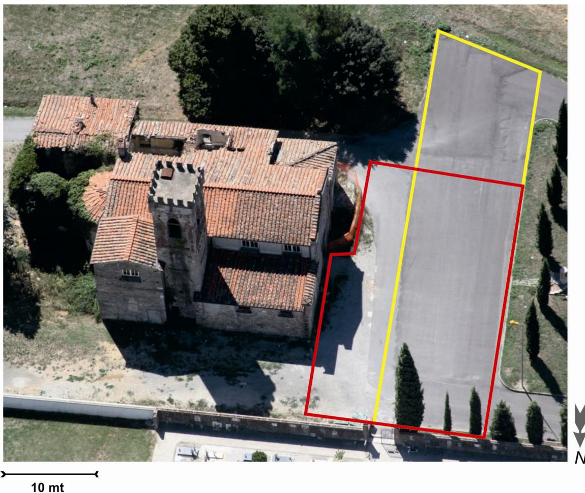
**Fig. 1** – Abbazia di Badia Pozzeveri. In rosso l’area soggetta ad indagine GPR monocanale, in giallo area soggetta ad indagine GPR multicanale.
