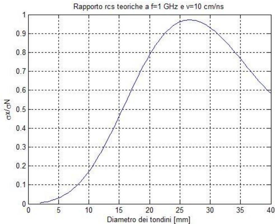
**Fig. 1:** Rapporto tra la RCS teorica in polarizzazione cross e quella in polarizzazione normale (calcolate a  $f=1$  GHz e  $v=10$  cm/ns), in funzione del diametro dei tondini.
